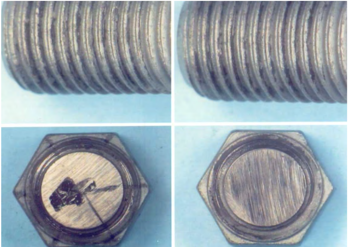
Figura 4.54 – Regiões de contato, face de apoio da cabeça e região roscada da tecnologia “B”.
