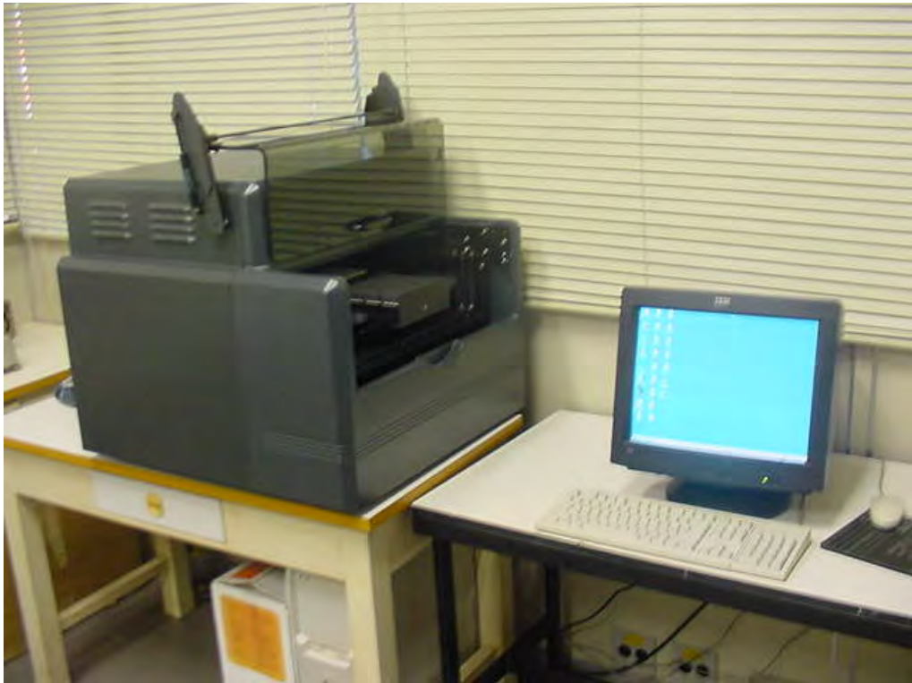
Figura 3.8 – Equipamento CMI Série 900 utilizado para medições de espessura.
