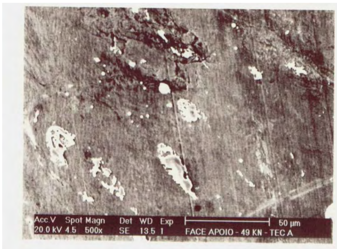
Figura 4.62 – Detalhe da região mais interna (Fig. 4.61) evidenciando uma completa deformação plástica do revestimento.
