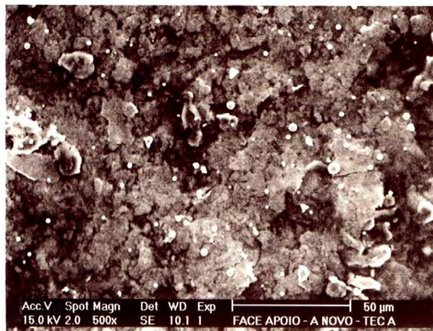
Figura 4.11 – Maior ampliação (500x) da face de apoio da cabeça, os resíduos esféricos tratam-se de elementos estranhos à superfície (sujeiras na amostra).
