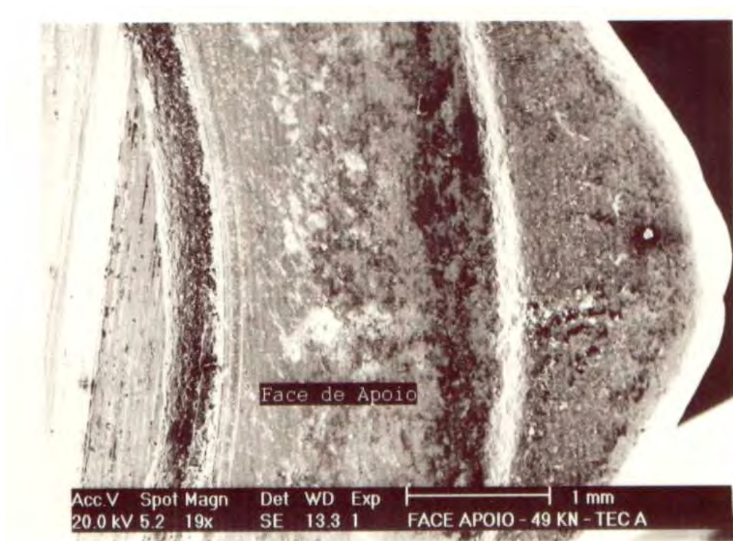
Figura 4.61 – Face de apoio da cabeça do parafuso submetida à carga de 49 kN.
