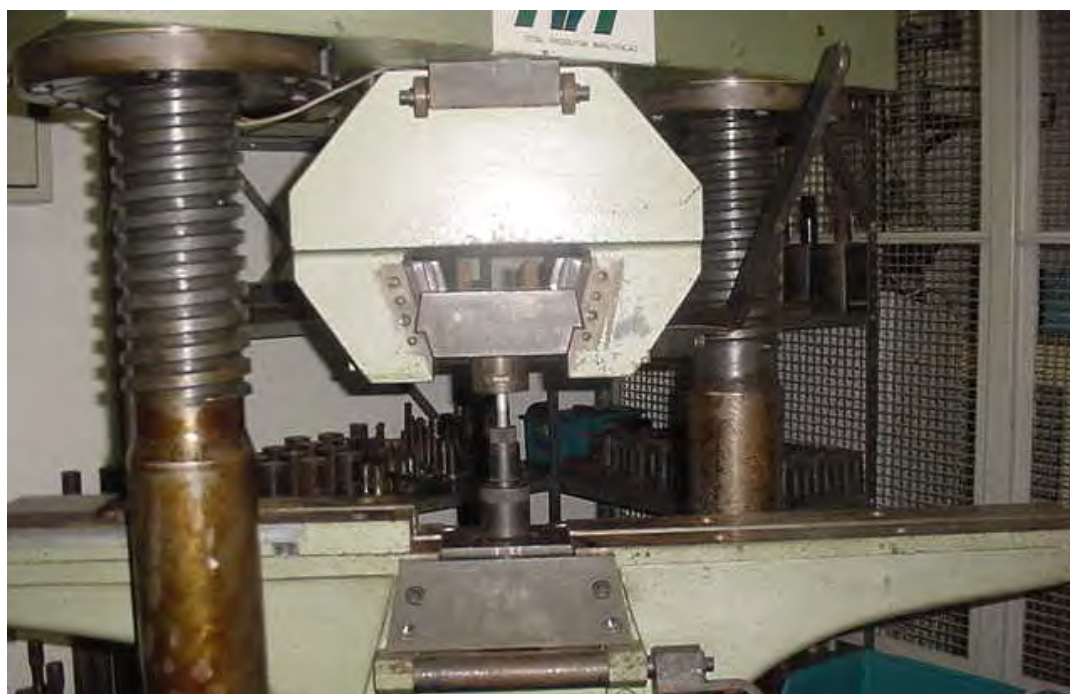
Figura 3.4 - Detalhe do parafuso montado nos dispositivos para ensaio de tração.
