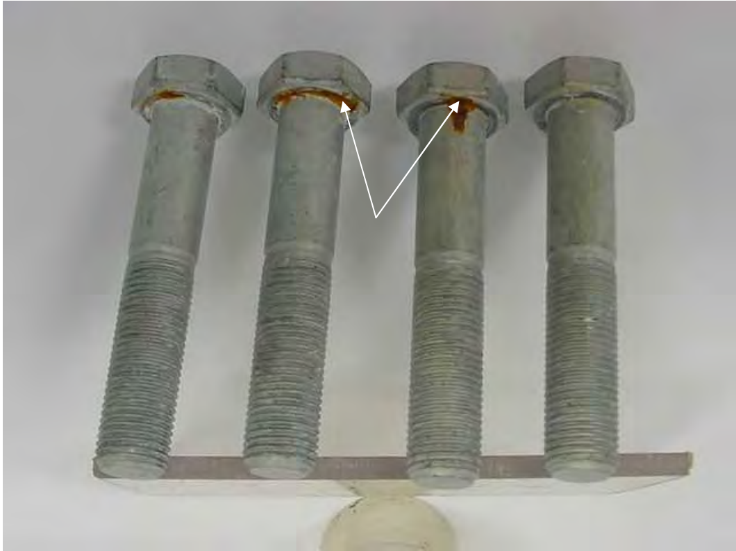
Figura 4.57 – Parafusos após teste de névoa salina onde se verificam focos de oxidação ferrosa sobre a face de apoio da cabeça.
